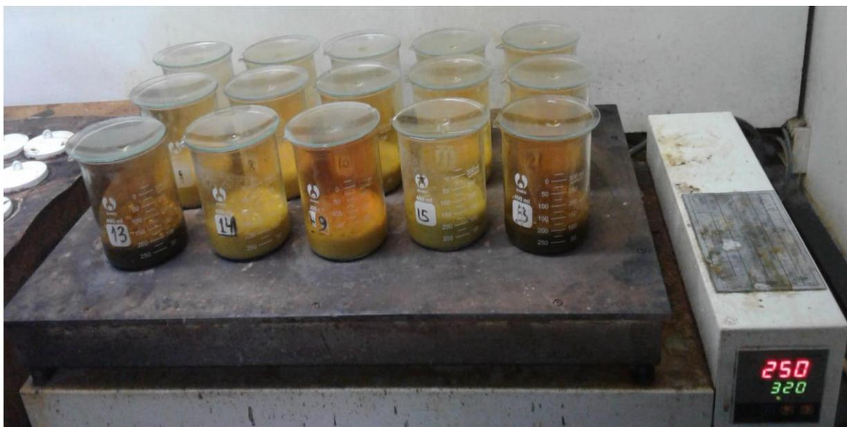
**Рисунок 3.7** – Растворение и нагревание проб на электронагревательной плите
